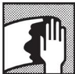
**Черные металлы, сталь:** очистка поверхности, шлифование (удаление ржавчины и слоев окалины), обезжиривание при помощи Очистителя силикона Транслак.
